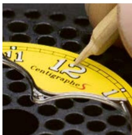
*Positionnement d'un chiffre lumineux sur le cadran du Centigraphe.*
