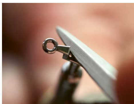
Reprise d'angle d'un pont volant d'égalité avec une lime.
