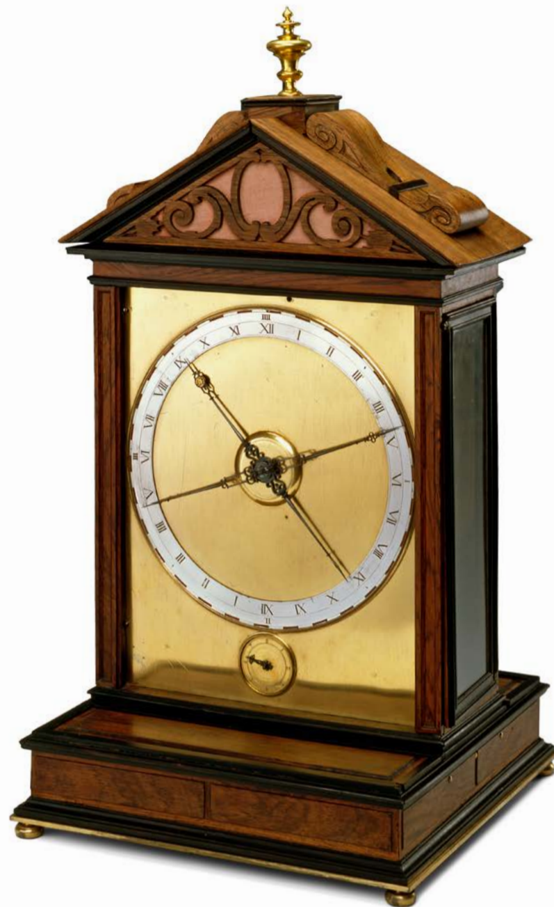
Remontoir d'égalité et échappement à bras croisés par Jost Bürgi - Prague, vers 1625. Caisse en palissandre et en ébène, vitrée sur trois faces avec vase en laiton en guise de système de remontage.
