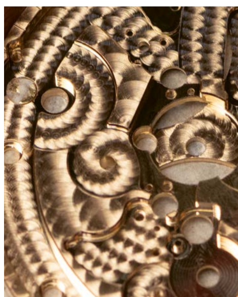
Perlage main d'une platine.
